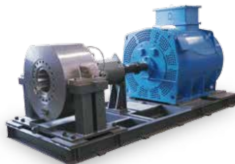
二代加余热排出泵
